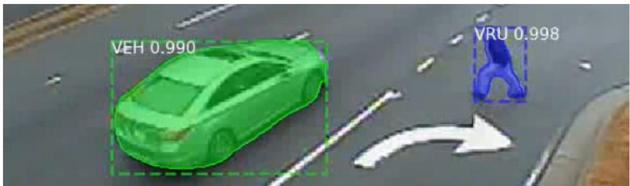
Figure 1 □ Outil d'analyse vidéo automatisée de Miovision pour recenser les accidents évités de peu
